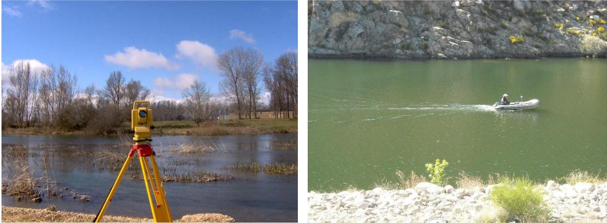
Figura 1. Toma de datos cauce mediante estación total y ecosonda acoplada a embarcación
